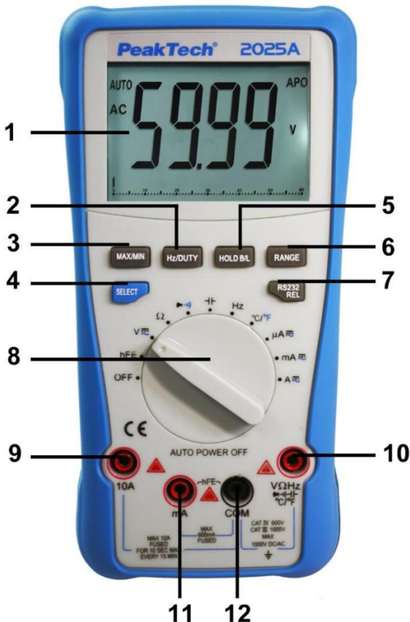
1. LCD de 3 5/6 dígitos (5999) con retroiluminación
