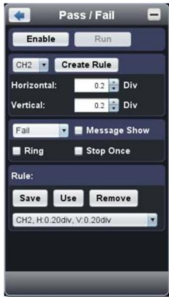
Detecta si la señal de entrada está dentro de los límites de la norma. Si excede el límite de la norma, se considera "Fail", de lo contrario, se considera "Pass". También puede emitir señales de fallo o pasa mediante un puerto de salida integrado y configurable.
