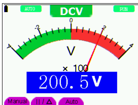
Fig. 25: Medición de tensión CC
