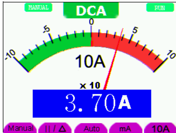
Fig. 24: Medición de corriente CC para 10 A
