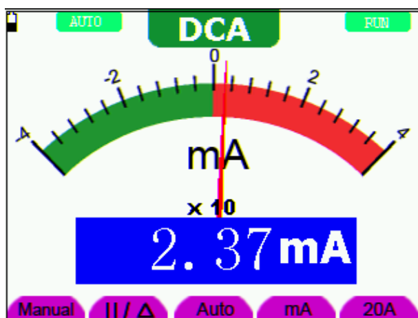
Fig. 23: Medición de corriente CC para 400 mA
