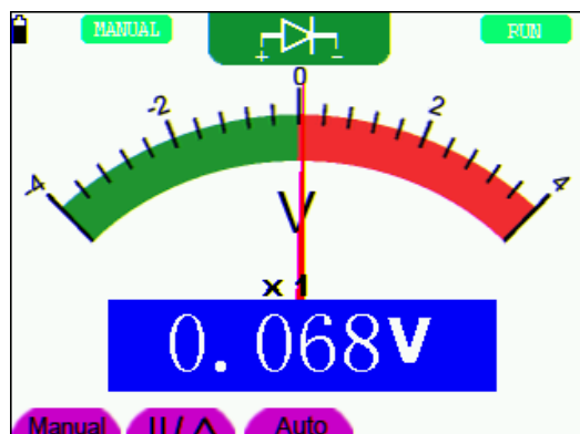
Figure 18: Medición de diodo.
