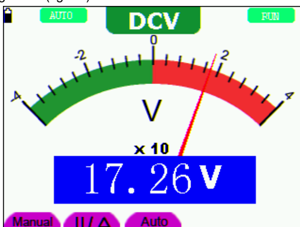
Fig. 21: Medición de tensión CC
