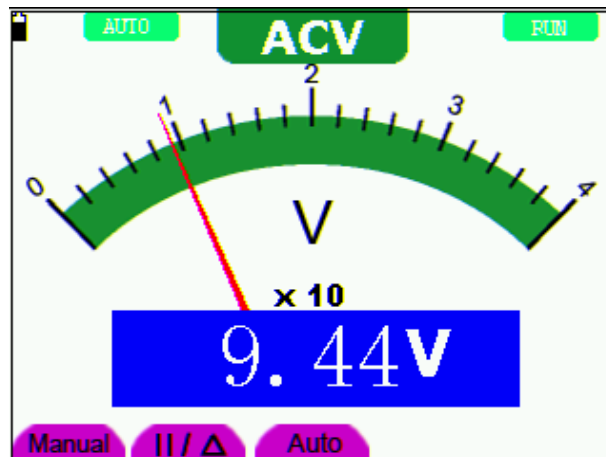
Fig. 22: Medición de tensión CA
