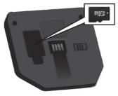
Retire el monitor usando el cierre deslizable (3) de la unidad principal. Abra la tapa como se muestra en la ilustración anterior e introduzca la tarjeta micro SD en el soporte provisto. En el momento de la entrega, la tarjeta micro SD ya está insertada en el dispositivo.
