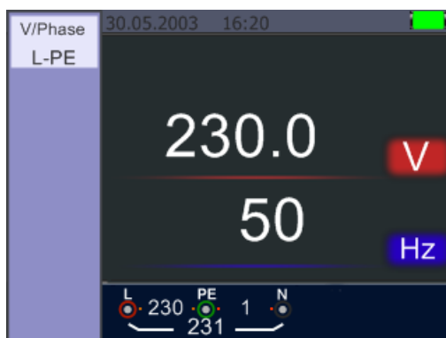
Pantalla en medición de tensión y frecuencia
