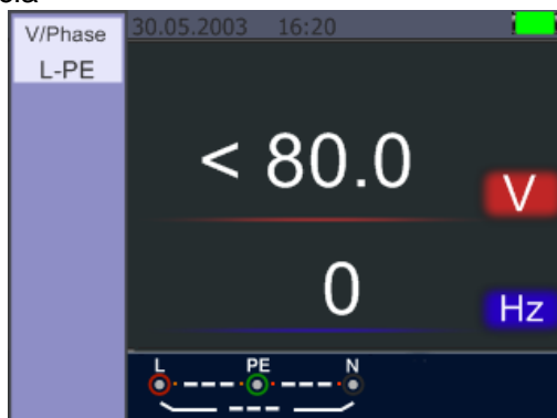
Pantalla de Standby para tensión y frecuencias
