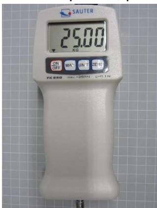
4. El peso correspondiente se fija ahora al gancho. El aparato **debe mantenerse inmóvil mientras se fija el peso**; evite que se sacuda. Consejo: sujete el aparato con ambas manos mientras apoya ambos codos sobre una mesa o sujételo a un objeto fijo (banco de pruebas).
