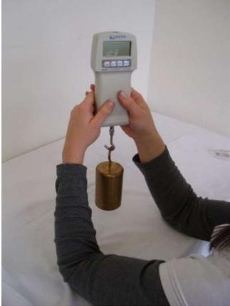
5. Esta posición se mantiene hasta que aparece **"F"** en la pantalla. A continuación, se puede retirar el peso y el ajuste queda completado. Sin embargo, si aparece **"E" en la pantalla**, repita los pasos **1 a 5 hasta que se confirme un ajuste correcto con "F"**.
