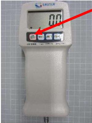
2. En cuanto aparezca "0" en la pantalla, pulse simultáneamente la tecla **"UNIT"** y la tecla **"ZERO"** hasta que aparezca **"CAL"** en la pantalla.
