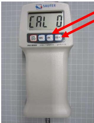
3. Transcurridos unos segundos, aparecerá en la pantalla el **peso de calibración** requerido, por ejemplo, 5,00 kg para el FK 50 o 10,00 kg para el FK 100.
