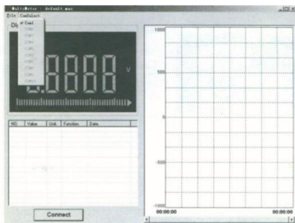
8. Encienda el medidor y pulse la tecla USB durante más de 3 segundos seguidos para iniciar el modo de comunicación. El símbolo "PC-Link" aparecerá en la pantalla LCD.
