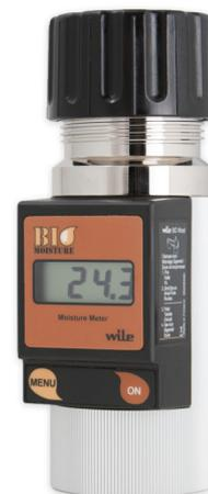
Para hacer la medición, tome la cantidad requerida de muestras de madera usando una motosierra. El medidor muestra el contenido de humedad de la muestra en porcentaje en peso.
