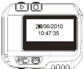
Una vez en el proceso de ajuste de los segundos, pulsando la tecla
