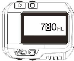
Pulsando el botón ▷, se ilumina el dígito binario 1. Se puede cambiar e introducir de 0 a 9 pulsando la tecla □.
