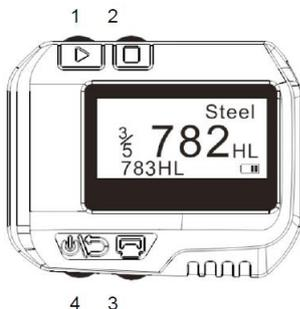
1. ▷ **"Siguiente"** , para la selección de materiales, escala de dureza...
