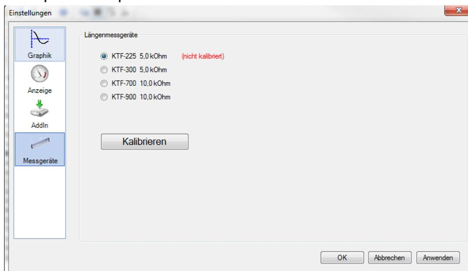
elegir el potenciómetro para medición de longitud adecuado El número indica la longitud en mm, hasta la cual puede ser usado el potenciómetro para medición de longitud.
